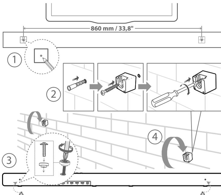
1. Percez dans le mur 2 trous parallèles (de Ø 5,5 - 6 mm chacun, selon le type de mur). La distance entre les trous doit être de 860 mm/33,8".
