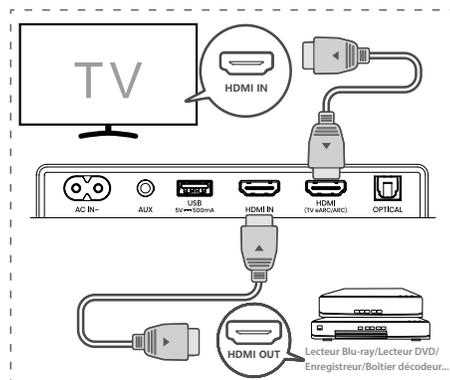
1. Utilisez un câble HDMI pour connecter la prise **HDMI OUT (eARC/ARC)** de la barre de son à la prise HDMI IN du téléviseur.
