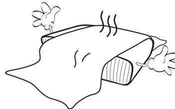
Wenn die Belüftungsöffnungen blockiert sind, kann Überhitzung im Projektor zu einem Brand führen.
