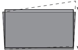
Drehen Sie die Konsole gegen den Uhrzeigersinn, bis der untere Bildrand parallel zur Leinwand ist.
