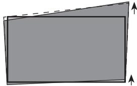
Drehen Sie den vorderen rechten Standfuß im Uhrzeigersinn.
