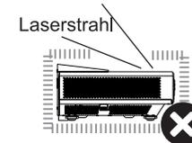
Lassen Sie mindestens den in der Abbildung unten gezeigten Platz frei, damit das Gerät gut belüftet wird.
