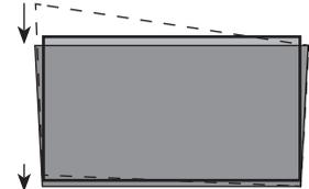
Drehen Sie die Konsole im Uhrzeigersinn, bis der untere Bildrand parallel zur Leinwand ist.
